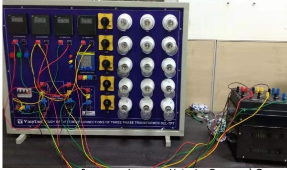
तीन चरण के ट्रांसफॉर्मर के लिए प्रायोगिक व्यवस्था विद्युत अभियांत्रिकी प्रयोगशाला में कार्यरत छात्र
