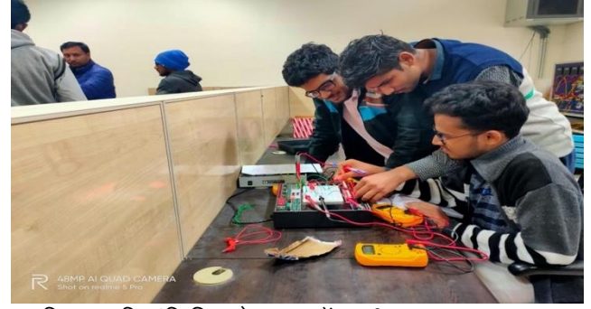
तीन चरण के ट्रांसफॉर्मर के लिए प्रायोगिक व्यवस्था विद्युत अभियांत्रिकी प्रयोगशाला में कार्यरत छात्र
